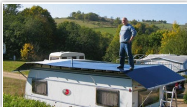
Komplett begehbare Dach durch Kederverschweißung
